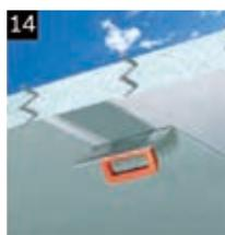
14 Rivestimento delle lamine Sika in CFRP Sika® CarboDur® con una rasatura cementizia (ad esempio Sika MonoTop®-621 Evolution) e successiva verniciatura (ad esempio Sikagard®-550 W Elastic).
