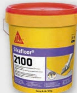
Malta colabile tricomponente epossi-cementizia a basso spessore. Per pavimentazioni industriali umide o sottoposte a risalita capillare di umidità. Spessore 2÷3 mm.
