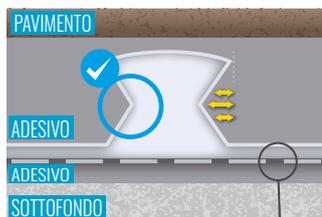
L'esclusivo disegno della struttura tridimensionale dello strato in HDPE permette valori di adesione da primato.
