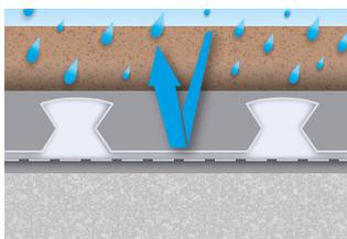
Lo strato continuo in HDPE garantisce immediatamente la tenuta idraulica.
