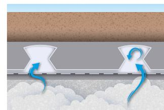
Il vapore generato da un'eccessiva Umidità Residua nel sottofondo sfoga la tensione nelle cavità vuote.
