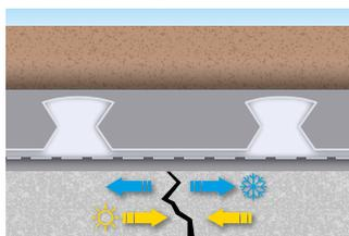
La struttura tridimensionale di STRATA\_MAT™ WP isola totalmente il pavimento dai movimenti del sottofondo.
